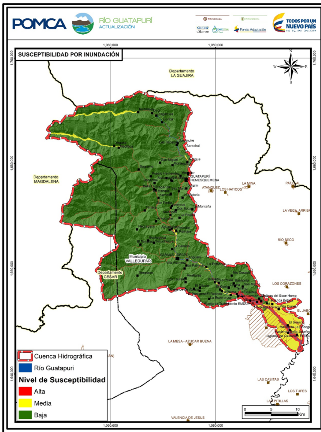
Mapa 7.34 Zonificación de susceptibilidad a inundaciones en la Cuenca del Río Guatapurí basada en la Metodología de Carvajal (2011). Zonificación de susceptibilidad a inundaciones en la Cuenca del Río Guatapurí basada en la Metodología de Carvajal (2011).
