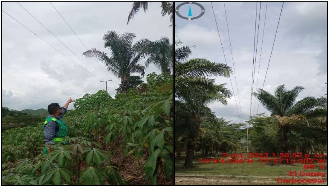
Imagen 66 y 67. de los árboles muestran la amenaza de entrelazarse las ramas con las redes eléctricas de media tensión, Recorrido kmz - tracks, zona rural de El Copey.
